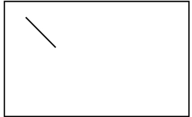
ANY DIAGONAL LINES ON THE SCREEN INDICATE A FAILURE IN THE RAM CHIP (A202).
